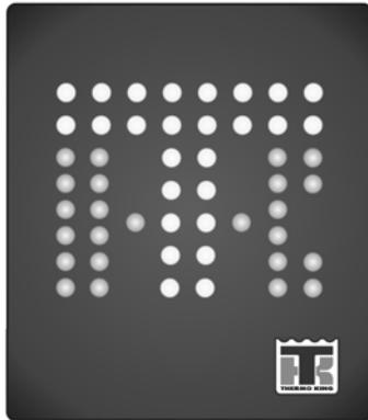
**Figure 13: Tela de status remota (mostrada em todos os LEDs)**
