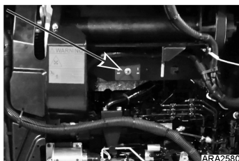
Imagem 8. Interruptor On/Off (Ligar/Desligar) do microprocessador
