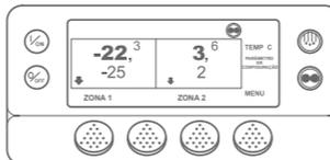
Nas novas unidade SR-3 Spectrum, o ícone MONITORIZAÇÃO DE CICLO é exibido no modo MONITORIZAÇÃO DE CICLO e é ocultado no Modo Contínuo, conforme ilustrado no ecrã.
