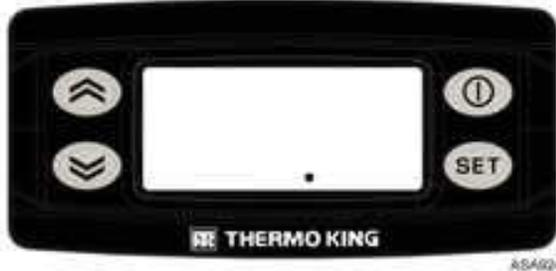
2. Prima o interruptor Ligado/Desligado situado na Caixa de Controlo da cabina durante pelo menos 1 segundo. O visor da Caixa de Controlo da cabina será activado.
