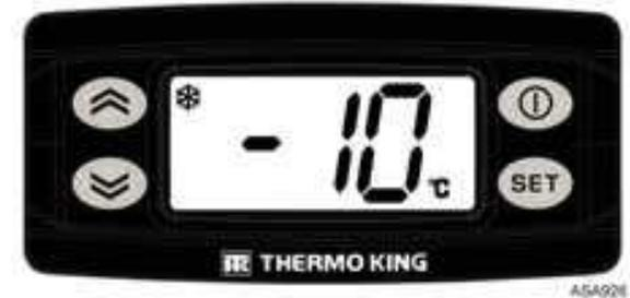
3. Prima as teclas de seta PARA CIMA e PARA BAIXO para seleccionar a Temperatura do Ponto de Regulação pretendida. De cada vez que premir e soltar uma destas teclas, a Temperatura do Ponto de Regulação será alterada em 1 grau. A Temperatura do Ponto de Regulação será também alterada continuamente se a tecla PARA CIMA/PARA BAIXO for premida continuamente sem ser libertada.
