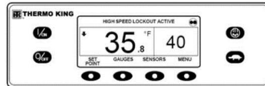
**Figura 53: Tela Padrão, Bloqueio em Alta Velocidade Ativo**
