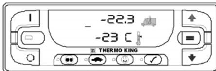
Temperatura da caixa e ícone da temperatura da caixa, temperatura do ponto de regulação e ícone do ponto de regulação
