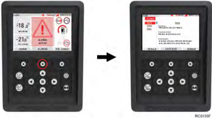
Ilustración 39. Se muestran las pantallas de alarma activa y de información de alarma
