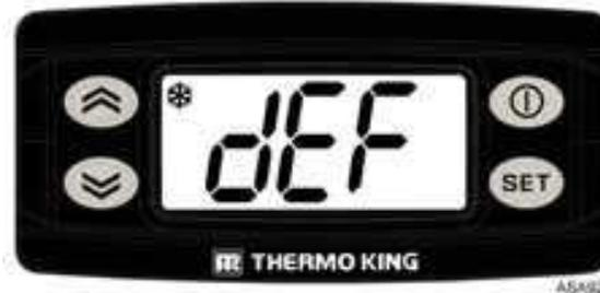
2. Para activar el descarche manual, pulse la tecla SET de ajuste durante 3 segundos.
