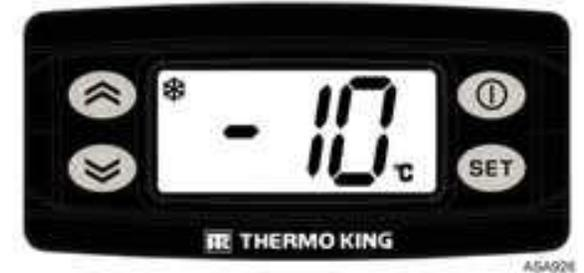
3. Pulse las teclas de dirección hacia ARRIBA o hacia ABAJO para seleccionar la temperatura del punto de consigna deseada. Cada vez que pulse y suelte alguna de estas teclas, la temperatura del punto de consigna cambiará 1 grado. La temperatura del punto de consigna también cambiará continuamente si mantiene pulsada la tecla de dirección hacia ARRIBA o hacia ABAJO sin soltarla.
