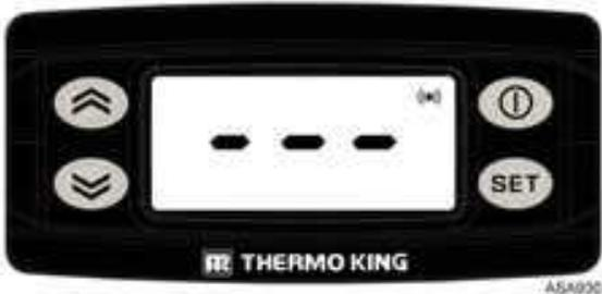
Pulse y suelte la tecla SET de ajuste dos veces para que se muestre el código de alarma actual en la pantalla. Si hay más de una alarma activa, se pueden visualizar todos los códigos de alarma de la unidad secuencialmente pulsando y soltando la tecla SET de ajuste y las teclas de las FLECHAS.
