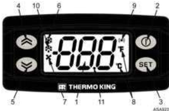
**1. Pantalla:** Se encuentra siempre activa, excepto cuando la unidad está desconectada (sin alimentación) o cuando está conectada pero se ha apagado manualmente desde el mando de control en cabina. Normalmente, muestra la temperatura del aire de retorno.
