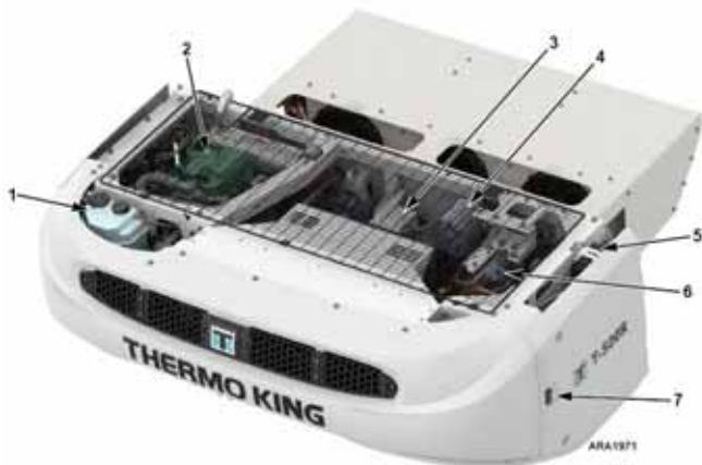
Ilustración 11: Componentes principales de la unidad T-560R
